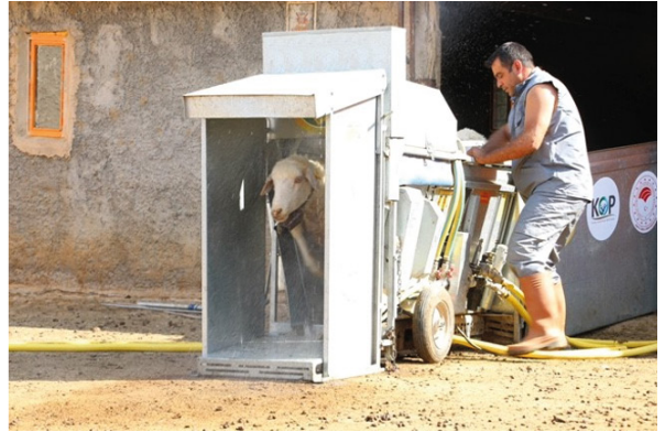
Resim 6. Küçükbaş hayvan yıkama makinesi
