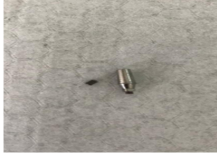
Şekil 6. Stres sonucu oluşan vida kırığı
