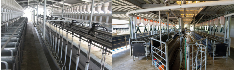
Şekil 28. Koyun ve keçilerde hızlı giriş-çıkış sistemine ait bir sağım ünitesi
