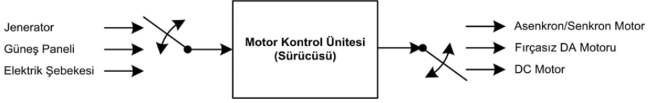
Şekil 6. Modern yapıdaki elektrik motor kontrol ünitesi (sürücüsü)
