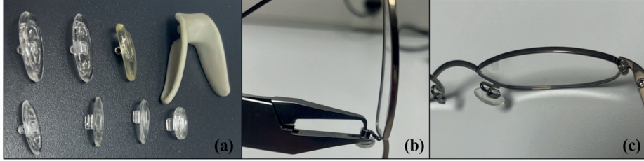
Şekil 9.35. Plaket değişimi. (a) Örnek plaket çeşitleri. (b) Plaket çıkartma pensesi ile plaketin çıkarılması. (c) Yeni plaketin takılmış görseli.
