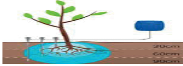
Şekil 12. Toprak su gerilimi sensör yerleşimi
