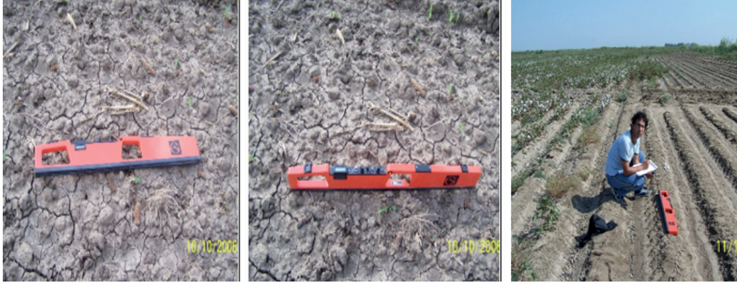
Resim 3. EM38 ile toprağın 0-1 m (dikey mod) ve 0-2 m (yatay mod) derinliği içerisindeki ortalama tuzluluk değerlerinin saptanması
