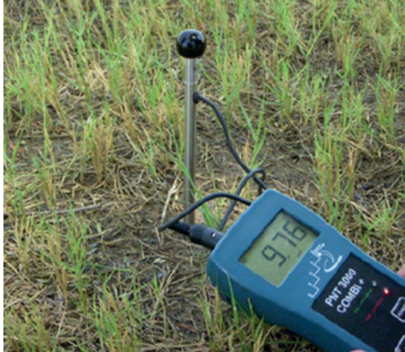
Resim 2. Tuzluluk probu kullanılarak bir çim sahada tuzluluğun izlenmesi. (PNT 3000 KOMBİ +)
