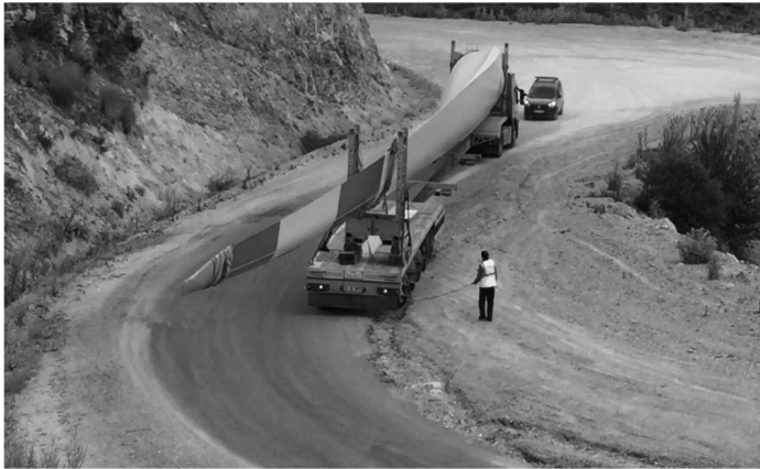
Şekil 3. Rüzgâr Türbini Kanadı Taşıma Esnasında (19)
