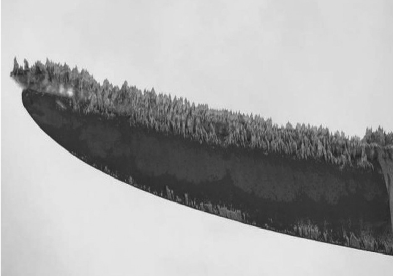
Şekil 7. Buzlanmış Bir Rüzgâr Türbin Kanadı (23)
