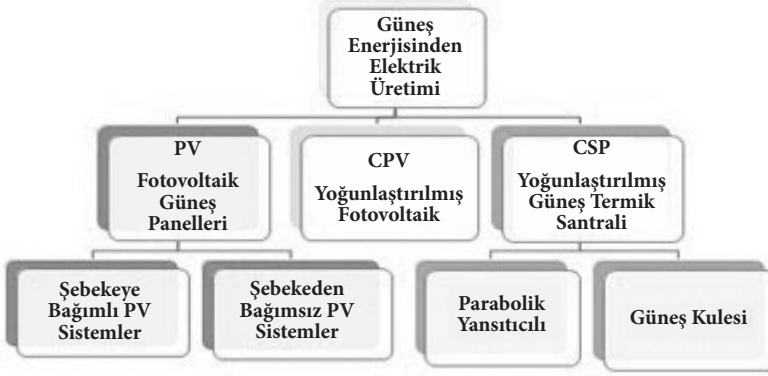
Şekil - 3 Güneş Işınım Enerjisinden Elektrik Üretimi [1]
