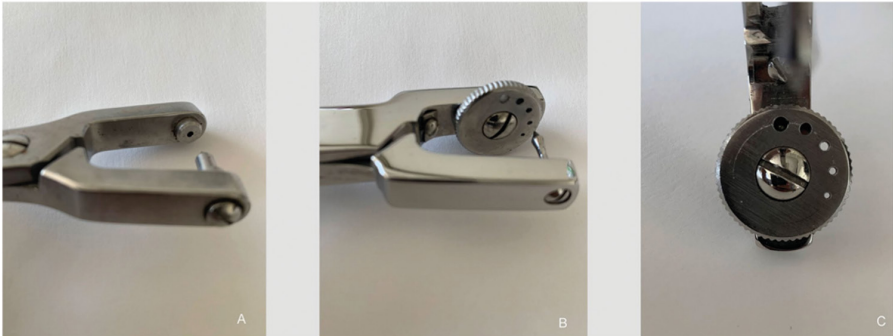
Şekil 5. Puncher: A) tek boy; B, C) en büyüğünden en küçüğüne kadar birden fazla boyut – mandibular molarlar/maksiller molarlar/premolar ve kanin dişleri/maksiller kesiciler/mandibular kesiciler (11)
