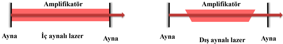
Şekil 4.1. a) İç aynalı ve b) dış aynalı lazerlerin gösterimi.
