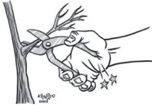
Şekil 1. Hatalı şekilde kısa saplı seçilmiş bir el aleti örneği (10)
