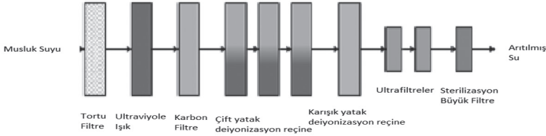
Şekil 5-4 PureFlow Purification Pack (PAK) bileşenleri. (NxStage Medical, Inc. Therapy Handbook NxStage® Hemodialysis Treatment. https://www.nxstage.com/wp-content/uploads/2019/08/NxStage-Hemodialysis-Treatment-Therapy-Handbook.pdf . Ağustos 2019'da güncellendi. 8 Ocak 2020'de erişildi.)
